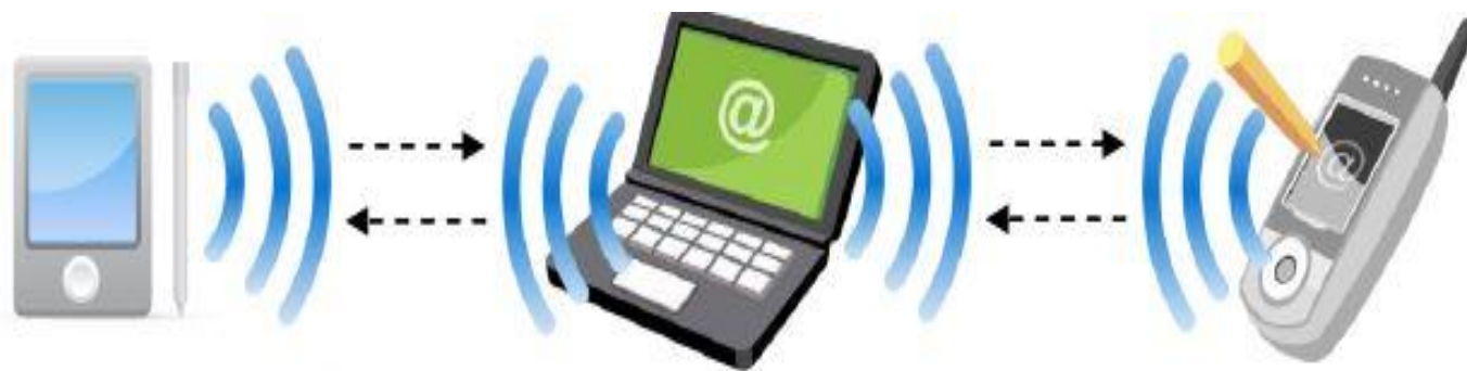
ภาพที่ 1.3 แสดงการเชื่อมต่อแบบแอดฮอคโหมด (ad hoc mode)
