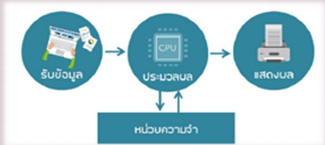
รูปที่ 1.18 แสดงหลักการทำงานของคอมพิวเตอร์
