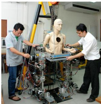
ภาพที่ 8.12 ชุดสวมขาหุ่นยนต์ ช่วยในการฟื้นฟูแรงของผู้พิการ
