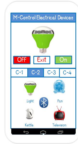
ภาพที่ 5 แสดงเมนูหน้าจอต่าง ๆ เพื่อควบคุมสั่งการทำงานเปิด/ปิดอุปกรณ์ไฟฟ้าทั้ง 4 ชนิด
