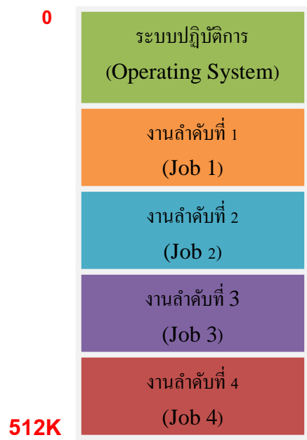
รูปที่ 1.3 แสดงพื้นที่ของหน่วยความจำสำหรับระบบการทำงานแบบหลายโปรแกรม
