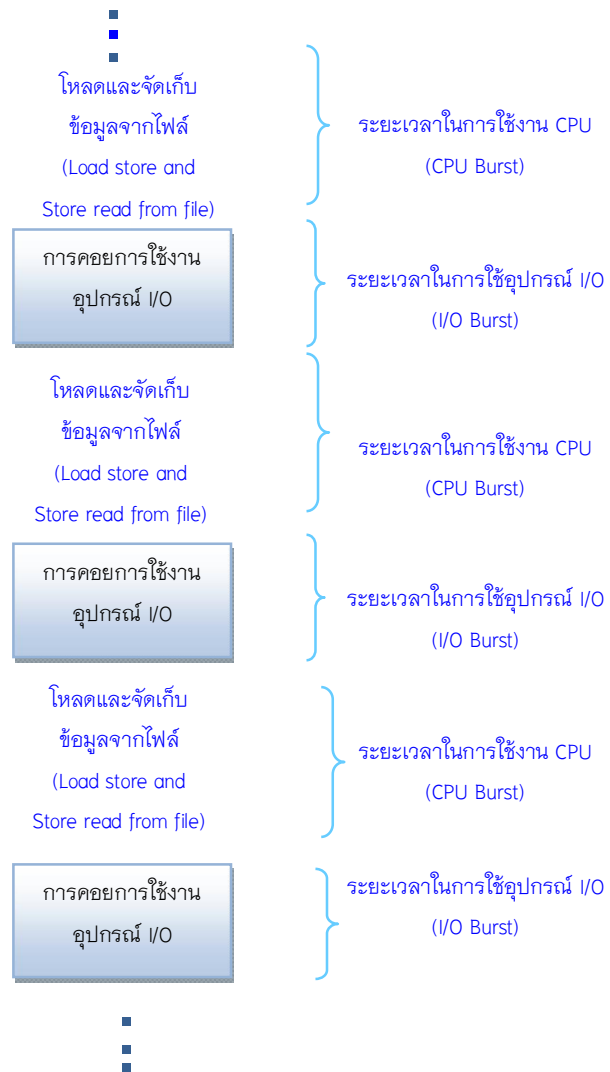
ภาพที่ 3.1 แสดงการสลับการทำงานระหว่างระยะเวลาใช้งานและระยะเวลาในการรับ-ส่งข้อมูล (Alternating sequence of CPU and I/O bursts)
